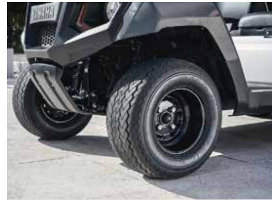
Bedingt geländetauglich: Die Bereifung ist für den gemischten Einsatz gedacht.
