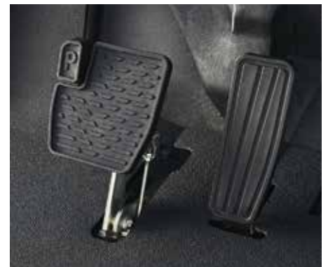
Einfach: Mehr Pedale braucht man nicht. "Gas" und Bremse, inklusive Feststellbremse.
